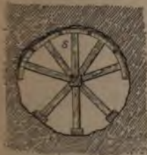
Fig. 183. — Coupe de la galerie et vue du blindage métallique.
